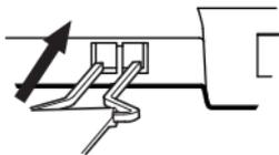
De clip moet in het deactiveringscontact blijven om de batterij gedeactiveerd te houden.
