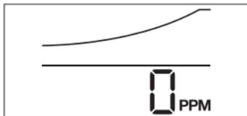
L'écran digital unique d'FireAngel affiche la quantité de CO que le capteur détecte, indiquée en parties par million (PPM). Il est conçu pour indiquer les niveaux de 10 ppm à 999 ppm.
