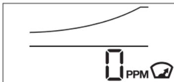
**REMARQUE** : il est possible et assez normal que le niveau du pic demeure à 0 ppm, ce qui signifie simplement que l'appareil n'a pas détecté de CO au cours de 4 dernières semaines.
